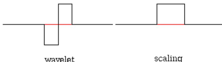
のような形のパルスを 2 ピクセルずつ横にずらして行って、基底を構成する<sup>\*23</sup>。左側をウェーブレット・ベクトルと呼び、右側をスケーリング・ベクトルと呼ぶ。
